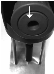
Verriegelungsrad für die Stifte der Masseverbindung:
